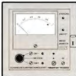
Einkanalgerät mit piezokeramischem Scherschwinger zur standardgerechten Messung der Schwinggeschwindigkeit nach RGW-St 3173-81, TGL 25 880 und DIN 45 666. Zur Überwachung von Lager-schwingungen an schnelllaufenden Maschinen wie Turbinen, Pumpen, Verdichtern, Separatoren, Lüftern und ähnlichen Anlagen. Für den Einsatz auf Schiffen geeignet. Zwei Grenzwerte (Vor- und Hauptwarnung) frei einstellbar. Selbstüberwachung.
