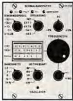
Universell einsetzbares, kontinuierlich durchstimmbares Filter, das in der Funktion als Bandpaß mit einer konstanten relativen Bandbreite, als Bandsperre, als Hochpaß oder Tiefpaß arbeiten kann. Frequenzeinstellung von Hand mittels Skalenantrieb und Bereichsumschaltung oder automatisch durch externe Steuerung (z. B. vom Pegelschreiber 02 013).
