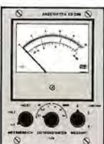
Indikator für Schwingungs- und Stoßmeßgeräte. Messung des Effektivwertes sowie des positiven und negativen Scheitelwertes der Meßgröße. Wechsel- und Gleichspannungsausgänge erlauben den Anschluß aller üblichen Registriergeräte einschließlich Analog-Digital-Umsetzern.
