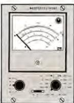
Effektivwertmesser mit streng linearer Anzeige in logarithmischem oder linearem Maßstab. Großer Dynamikbereich von 40 dB für Anzeige und Ausgänge. Grundbaustein für Schallpegelmeßgeräte durch eingebaute Bewertungsfilter A, B, C, D und Zeitbewertung Slow, Fast, Impuls, Wechsel- und Gleichspannungsausgänge erlauben den Anschluß aller üblichen Registriergeräte einschließlich Analog-Digital-Umsetzern.
