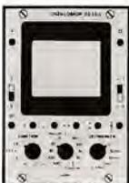
Spezialbaustein zur visuellen Auswertung periodischer und nichtperiodischer mechanischer Schwingungen und Stöße. Lange Nachleuchtdauer der Bildröhre.
