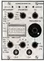
Universelle Signalquelle für Sinus- und Rechteckspannungen. Außerdem als Schmalbandfilter mit einer konstanten relativen Bandbreite von 30% oder 10% einsetzbar. Frequenzeinstellung manuell mittels Skalenantrieb und Bereichsschalter oder automatisch durch externe Steuerspannung (z. B. durch Pegelschreiber 02 013).
