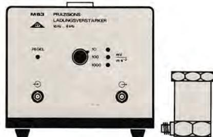
Zur Vergleichseichung (back to back) von piezoelektrischen Beschleunigungsaufnehmern. Besteht aus einem Beschleunigungswandler auf Quarzbasis Typ QD 20 und einem Ladungsverstärker M 63. Lieferung als Referenznormal 1. und 2. Ordnung.
