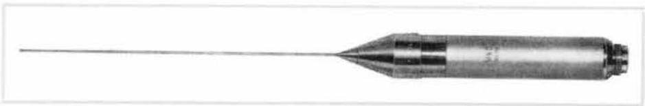
35 1-Zoll-Meßmikrofon mit Sonde 3 mm Ø
