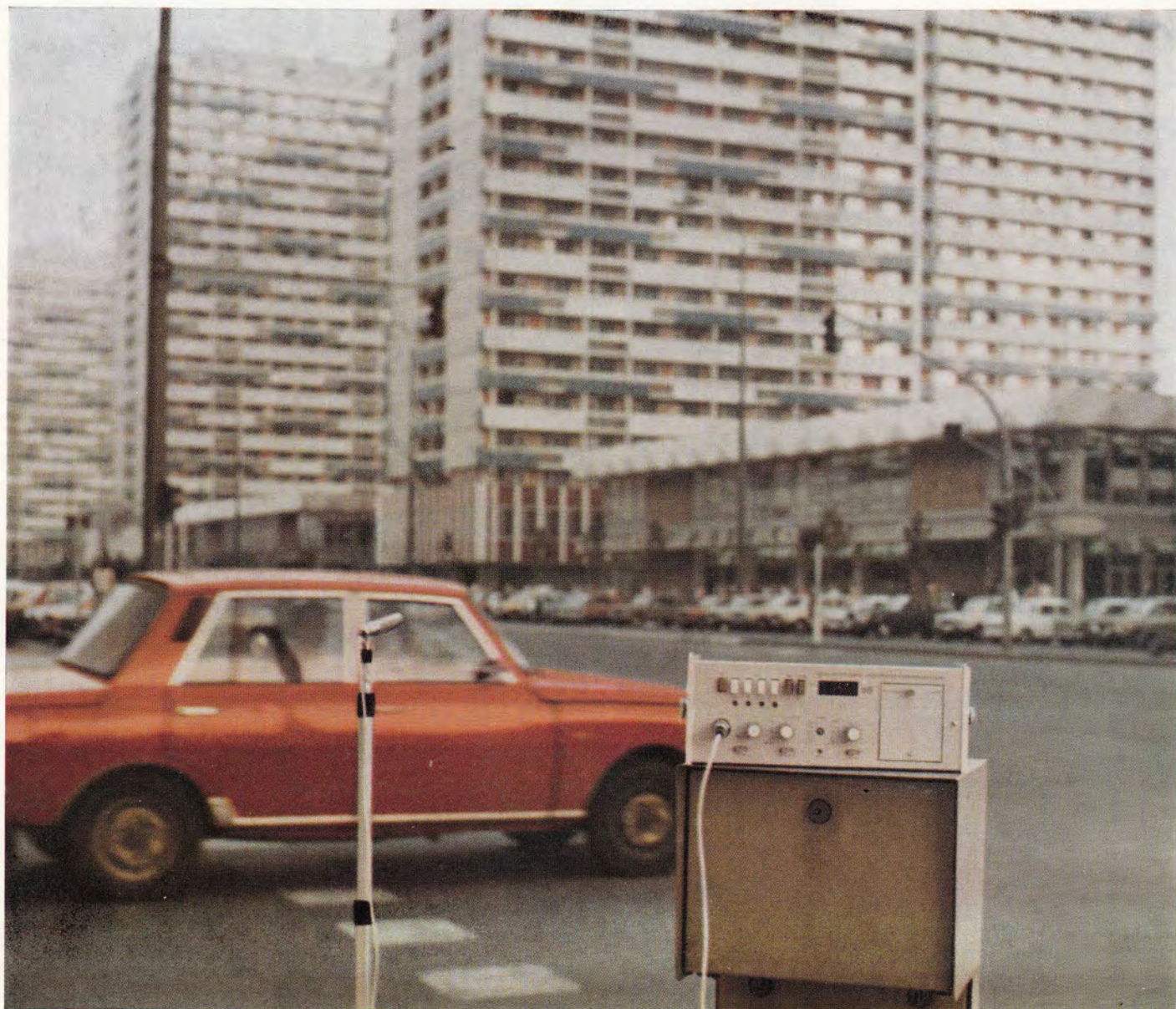
Bild 9 Verkehrslärmmessung mit dem Integrierenden Präzisionsschall- pegelmesser 00 026
